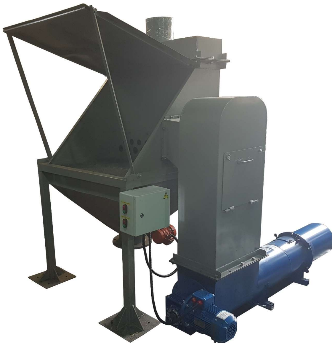
Растариватель мешков с уплотнителем, АО «Минудобрения», г. Россошь, август 2019
