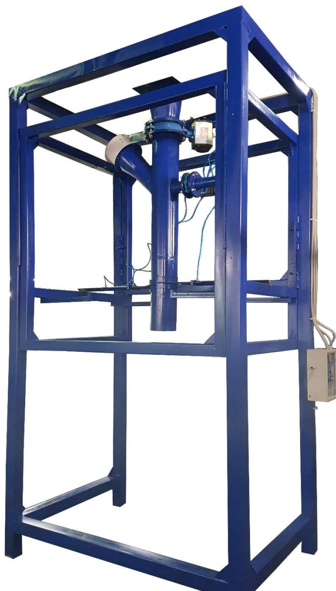
Станция затаривания сыпучих материалов ЗТ-1, г. Липецк, март 2018
